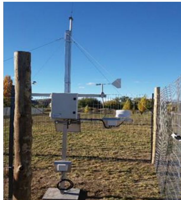
Fig. 2: Estación meteorológica automática Modelo NIMBUS de desarrollo tecnológico INTA (proyecto: "Desarrollo del Sistema de Observación y Análisis Climático y Ambiental").
