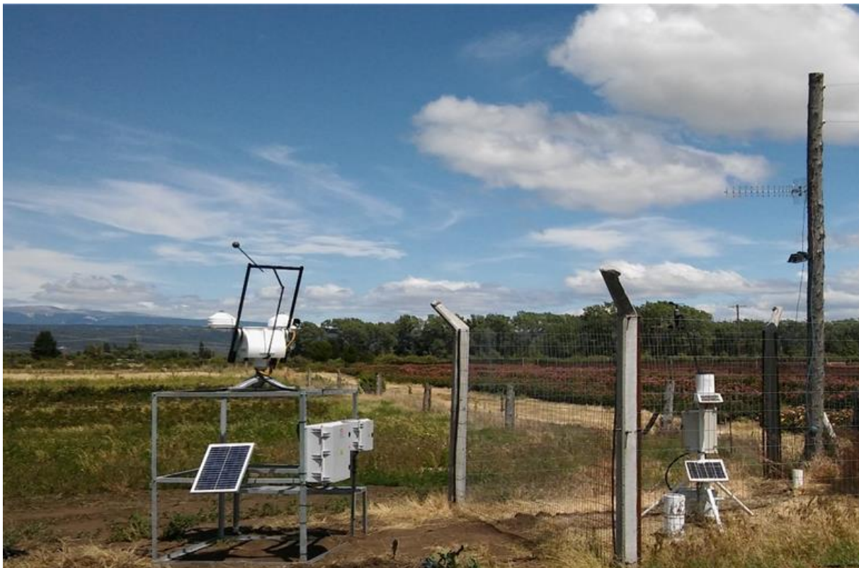
Fig. 3: Estación solarimétrica (EnArSol) de diseño argentino desarrollada por INTA (Laboratorio de Agroelectrónica), la Universidad Nacional de Luján (UNLU-GERSolar) y la Dirección de Tecnología de YPF SA.
