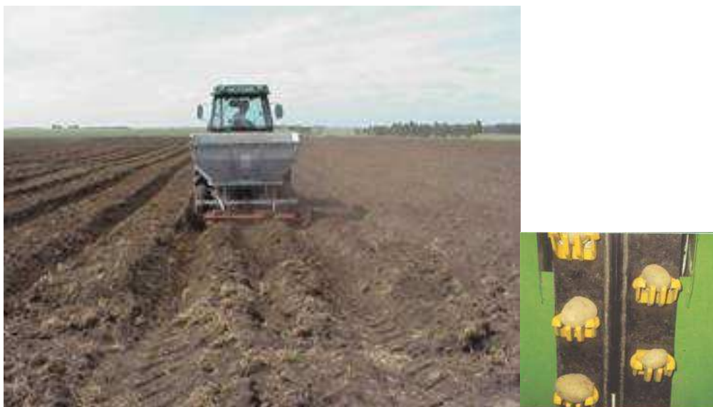
Figura 4 Plantación de papa en el SE Pcia de Buenos Aires y detalle de cangilones
