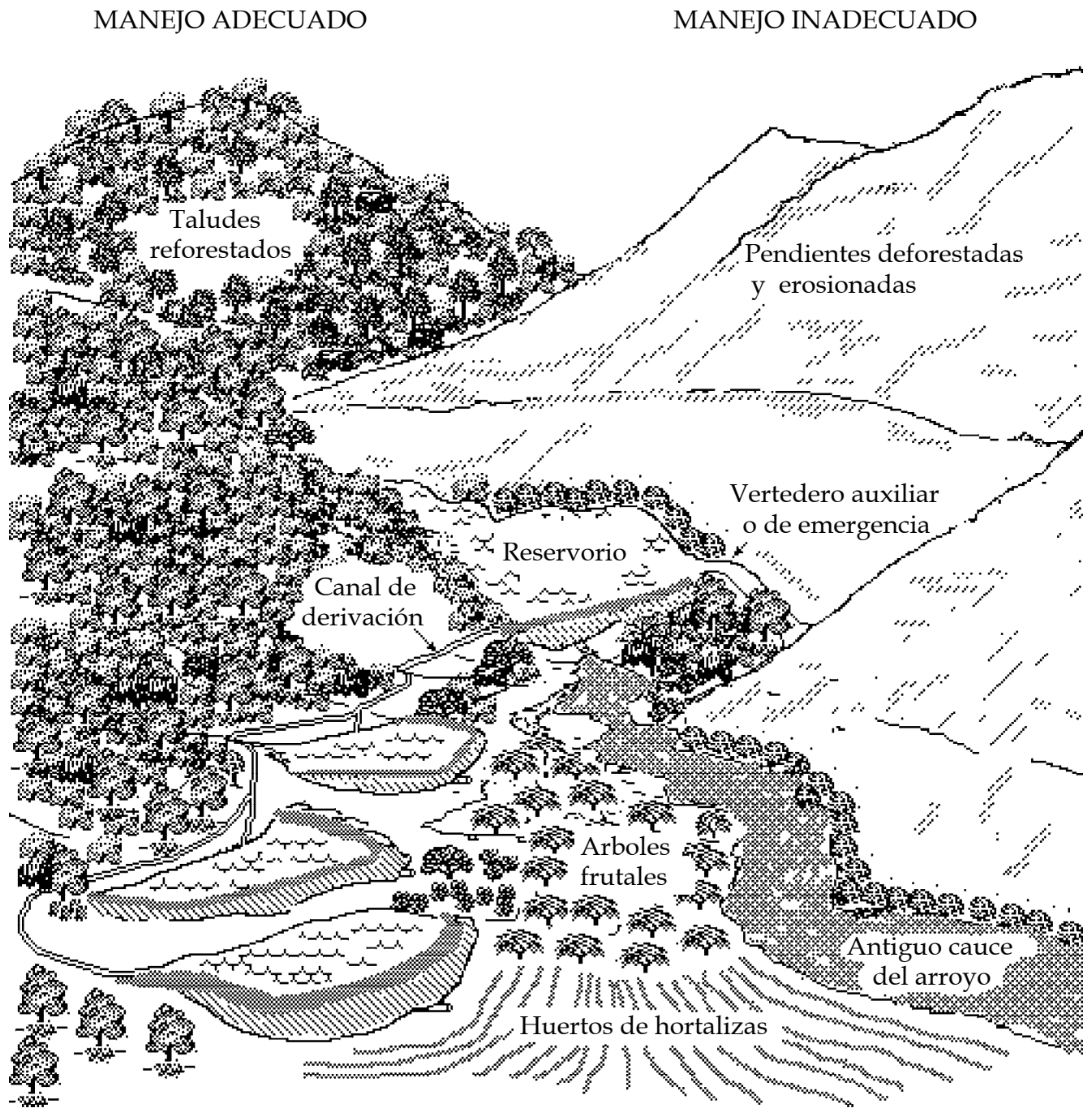
Figura 2: Pequeños valles como éste, contienen lugares con alto potencial para contruir estanques. Estos pueden ser contruidos en las partes bajas y planas de la pendiente del valle. Estos estanques pueden ser llenados con agua del arroyo derivado.
